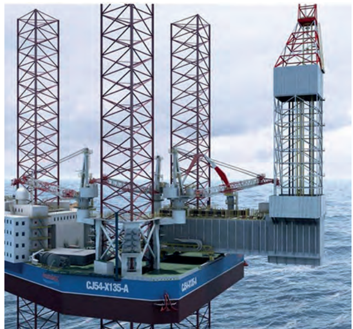
Een platform dat middels rack & pinion en jack-up systeem omhoog getild wordt.
